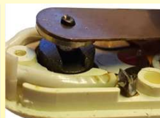
Circa 1972. Caja de control de potencia fabricada por Jidé en Limoges bajo la marca Jidéstat. El más exitoso de todos los sistemas. Muy pequeño en tamaño, es ajustable y se incorpora en el enchufe eléctrico. Es el único modelo con un contacto magnético de cierre rápido. No fue superado por sistemas electromecánicos hasta la era actual. (Colección Ulti- mheat)
