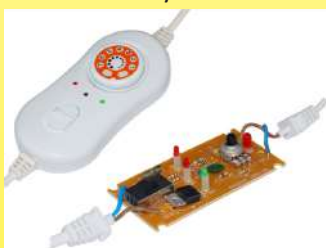
2019 Unidad de Control Continuo de Potencia Electrónica para Manta (Colección Ultimheat)
