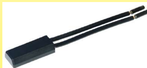
2019 Limitador de temperatura de rotura rápida para transformador de calefacción, derivado del modelo 7AM de Texas Instruments de 1966, utilizable a 230 V, en una carcasa impermeable de plástico. Rango de temperatura de 5 a 8 °C. Tipo V7AM. (Colección Ultimheat)
