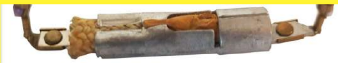
Limitador de temperatura de rotura lenta, utilizado junto con un sistema de control de energía inglés fabricado por GEC (General Electric Company). Está cubierto con una funda impermeable de PVC, soldada a los cables. Alrededor de 1970 (Colección Ultimheat)
