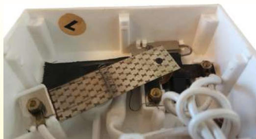
Circa 1970. Ajuste de potencia de GEC (General Electric, Inglaterra) en una manta térmica inglesa. La resistencia anticipada es claramente visible sobre la bimetálica y el interruptor lento (Colección Ultimheat).
