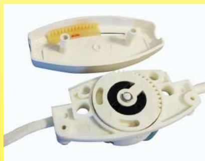
Interruptor calefactor de 3 posiciones y interruptor de apagado de 2 posiciones en manta térmica. Modelo intermedio entre sistemas rotativos y sistemas deslizantes (Circa 1970. Colección Gitem Ultiheat)
