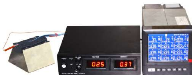
Equipo para medir la temperatura superficial en función de W/cm^2 de la manta térmica o el calentador de chaqueta
